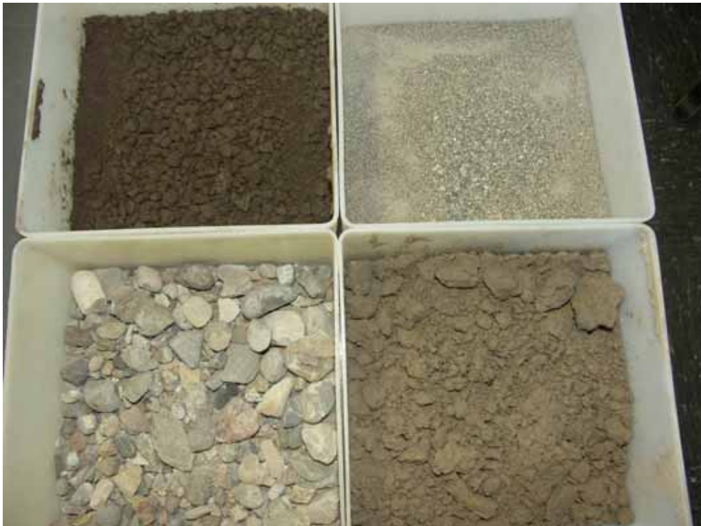
Abbildung Nr. 9 Böden unterschiedlicher Korngrössenbereiche: (von oben links In der Uhrzeigerichtung) Ton, Sand, Silt, Kies
