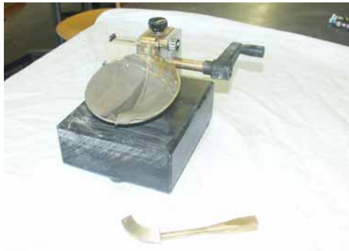
Abbildung Nr. 16 Klopffapparat A. Casagrande
