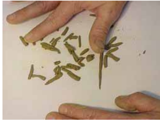
Abbildung Nr. 15 Bestimmung der Ausrollgrenze w_p
